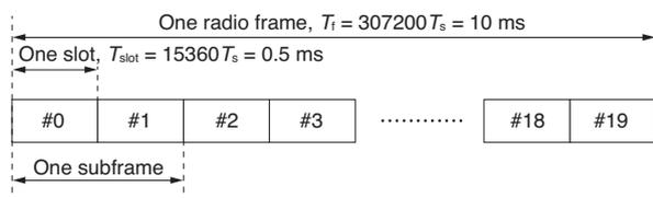
Fig. 3. LTE FDD frame structure<sup>(1)</sup>
