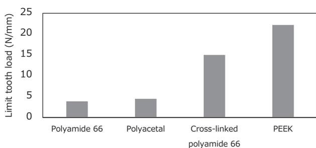
Fig. 4. Limit tooth load
